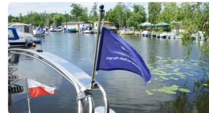
FLAGSZTOK - drążek flagowy z drzewca lub metalu, na którym mocowana jest bandera, flaga. Banderę na flagsztoku niesie jacht płynący na silniku
