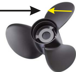
ŚRUBA LEWOKRĘTNA (spadek łopatki w lewo)
